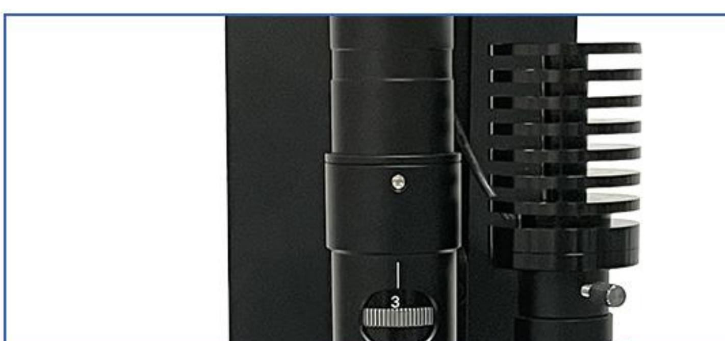
镜头自带光学倍率调节, 最小0.7倍, 最大5倍光学放大
