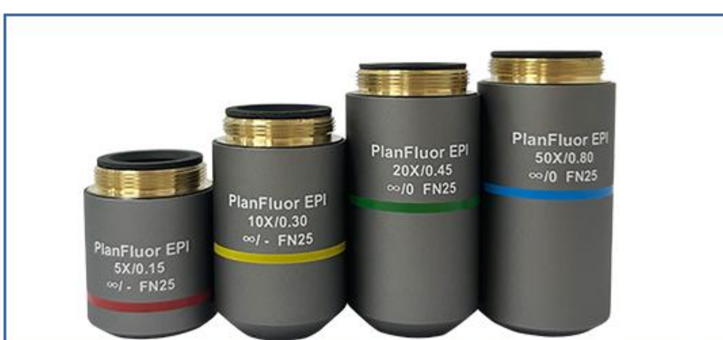
产品默认装配的10X的平场物镜。工作距离17.7mm, 孔径0.30mm。镜头接口直径20.2mm。
